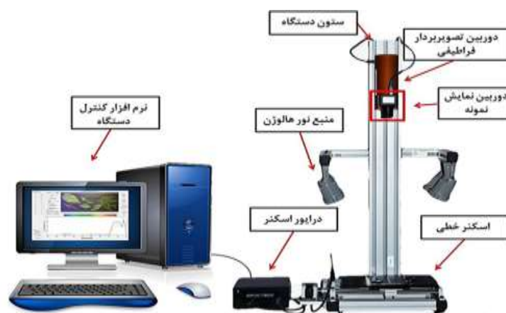
شکل ۱. اجزاء تشکیل دهنده دستگاه تصویربرداری ابرطیفی.
