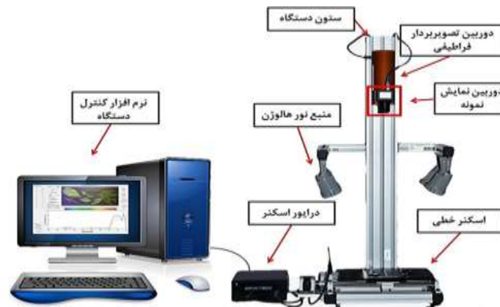
شکل ۱. اجزاء تشکیل دهنده دستگاه تصویربرداری ابرطیفی.
