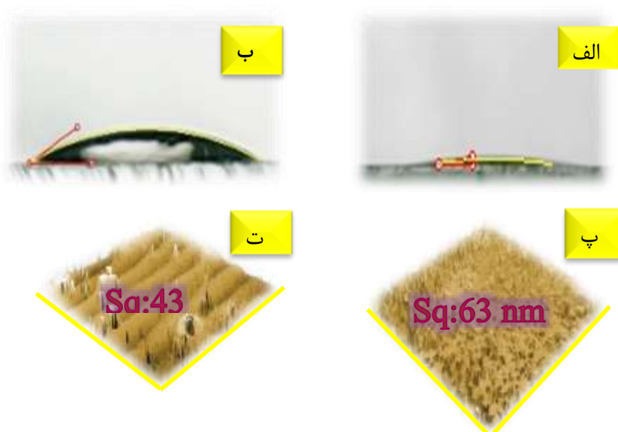
شکل ۲. الف) تصویر زاویه تماس قطره ی آب با سطح نمونه ی W-BVO ، ب) تصویر زاویه تماس قطره آب با سطح نمونه ی NaW-BVO برای بررسی ترشوندگی. پ) و ت) تصاویر میکروسکوپ کانفوکال برای بررسی زبری سطح مربوط به نمونه های الف) و ب).
