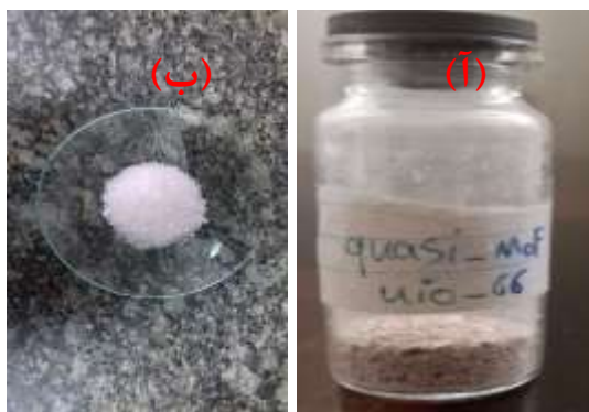
شکل ۱- (آ) Quasi MOF UIO-66 و (ب) 30% Fe/Quasi MOF UIO-66 (Zr)
