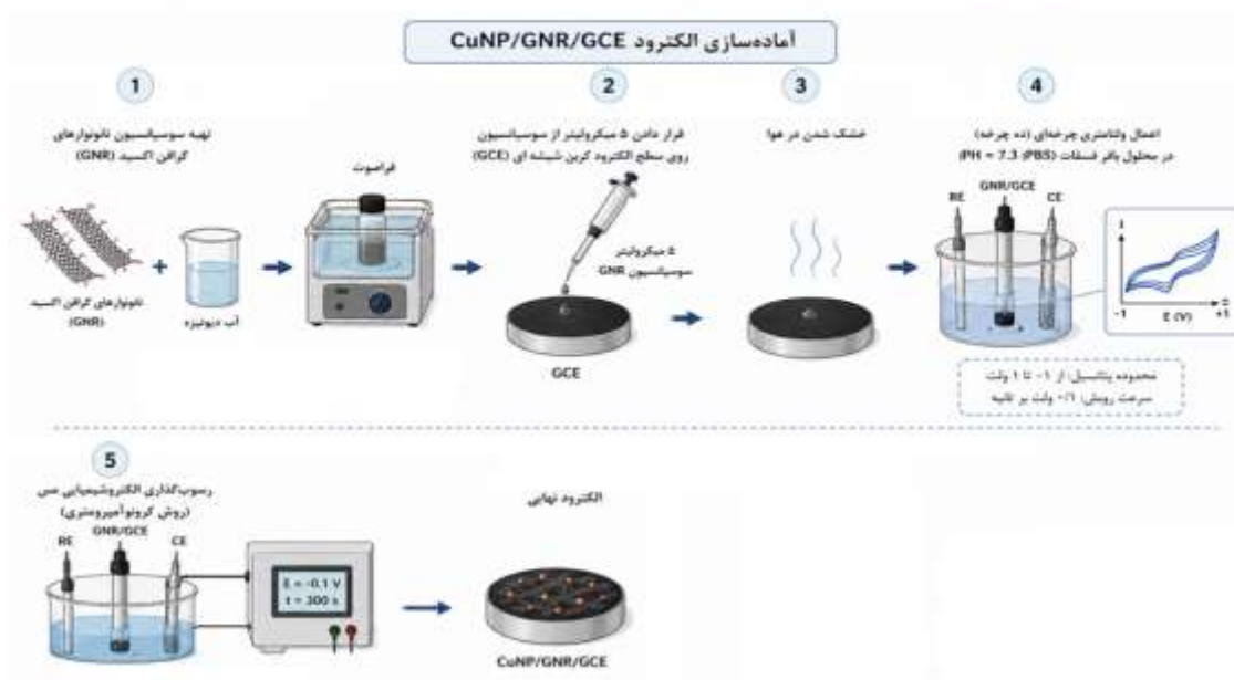
شکل ۲. مراحل تهیه نانونوارهای گرافن اکسید و اصلاح الکتروود
