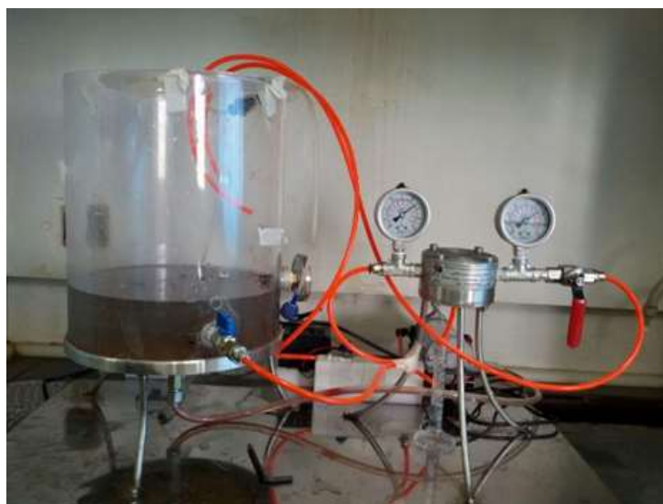
شکل ۱- سامانه مورد استفاده جهت تصفیه پساب و آزمایشات جذب
