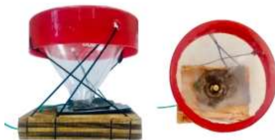
شکل ۵- ظرف مورد استفاده جهت آنالیز QCM از دو نما
