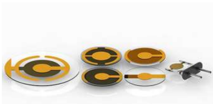
شکل ۳- انواع مختلف کریستال کوارتز همراه با لایه فلزی پوشش شده روی آن و پایه‌های اتصالات الکتریکی
