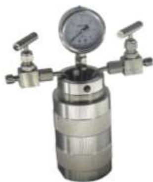
شکل ۴- راکتور اتوکلاو سنتزی با پوشش تفلون داخلی و با ورودی و خروجی گاز ساخت شرکت HUANYU که در تست های کاتالیزوری مورد استفاده قرار گرفت.
