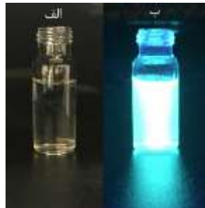
شکل ۹- تصویر بدست آمده در تاریکی برای واکنش‌های نورتابی شیمیایی سیستم لومینول ( 1 \times 10^{-3} مولار) \text{H}_2\text{O}_2 ( 1 \times 10^{-3} مولار) در 10 میلی مولار \text{PBS} ( \text{pH}=7 ) (الف) در غیاب کاتالیزگر (ب) در حضور نانوکامپوزیت \text{Fe}_3\text{O}_4/\text{SiO}_2/\text{TiO}_2/\text{Co}^{\text{III}}\text{THPP}
