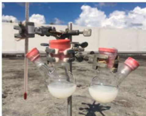
شکل ۲. سامانه انجام واکنش تحت تابش نور طبیعی خورشید
