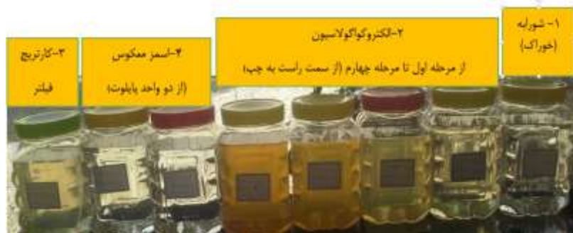
شکل (۶)- میزان آهن آزاد شده از آب خام مراحل اول تا چهارم الکتروکواگولاسیون، کارتریج فیلتر و واحدهای غشای اسمز معکوس در پایلوت
