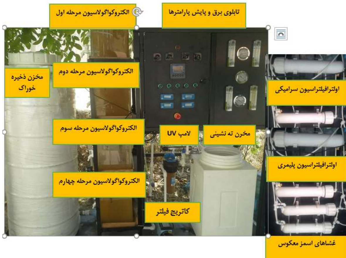
شکل (۳) - چیدمان راکتورهای الکتروکواگولاسیون SEBRs و فرآیندهای تصفیه تکمیلی در پایلوت
