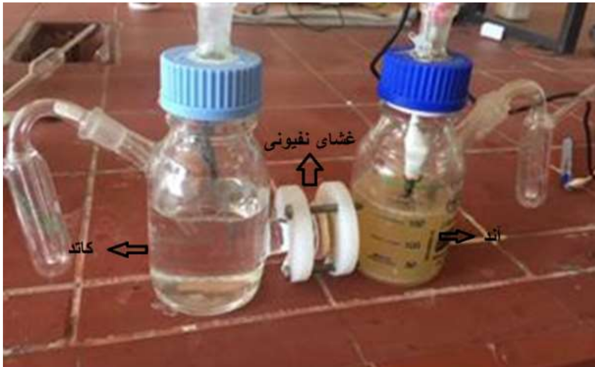
شکل ۲: نمایی از پیل سوختی میکروبی به کار برده شده در این کار پژوهشی
