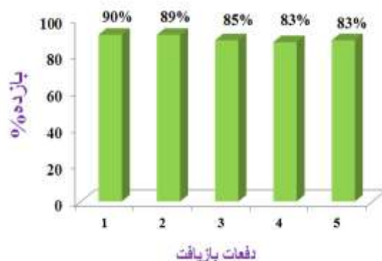
شکل ۷. بازیافت کاتالیست Pd/SiC
